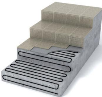
Bei großen Treppen/Podesten können im Einzelfall ebenfalls Heizmatten zum Einsatz kommen. Aufgrund der oft sehr kleinen Einzelflächen kommt die Heizleitung SIPCPBA oder 61xx mit einseitigem Anschluss zum Einsatz. Auf dem Untergrund (Rohrtreppe) der zu beheizenden Flächen wird die Heizleitung SIPCPBA oder 61xx mit Montagestegen oder Montageband befestigt. Der Heizleitungsabstand ergibt sich aus der benötigten flächenbezogenen Leistung, W/m<sup>2</sup>.
