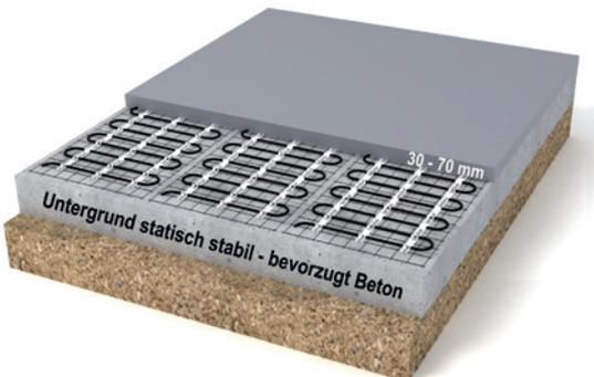
Auf der Betonsohle des Untergrundes werden die Heizmatten/ Heizschleifen entsprechend der elitec Planungsunterlagen ausgelegt und ggf. am Untergrund befestigt. (Achtung evtl. vorhandene Abdichtung nicht beschädigen!) Die Kaltleiter werden seitlich an den Heizmatten vorbei zu den Anschlusspunkten geführt.
