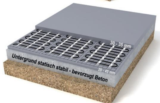
Sollte baulich bedingt eine stärkere Estrichschicht gefordert sein, so wird vor der Verlegung der Heizmatten erst eine Schicht Estrich geschüttet, dann werden die Heizmatten verlegt und direkt danach wird die zweite Schicht Estrich eingebracht. (siehe linke Abbildung, Nass-in-Nass Verfahren).
